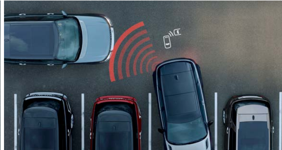
Система виявлення транспорту, що наближається, під час руху заднім ходом
