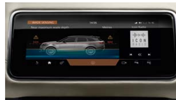
Система Wade Sensing
