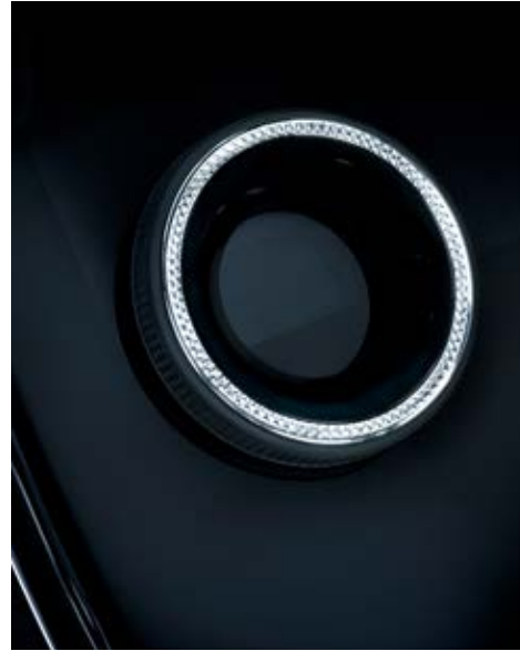
На бічну поверхню поворотних перемикачів нанесено приємне на дотик рифлення.
